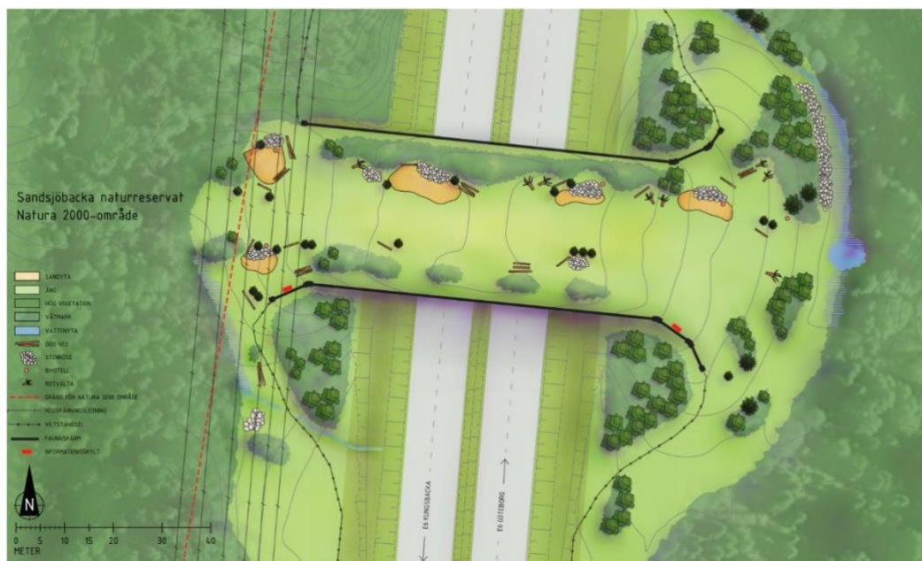
Figur 14. Skiss på faunapassagen i Sandsjöbackaområdet. Skiss: Trafikverket
